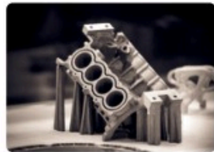
شكل 3.4: مجسم مطبوع بواسطة آلة تليد بالليزر
