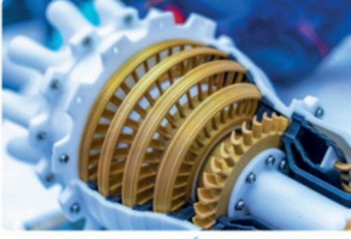
شكل 3.17: محرك نفّاث مطبوع على شكل نموذج بلاستيكي معدني
