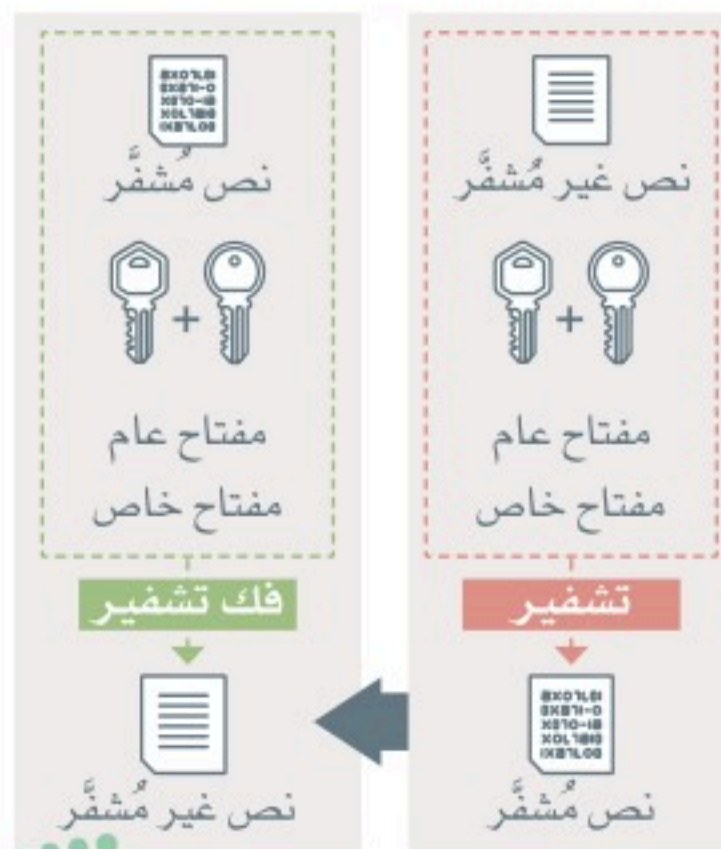
شكل 3.5: عملية التشفير باستخدام المفتاح غير المتماثل
