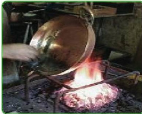
الشكل (٦٧): التخمير «تسخين المعدن لإكسابه اللدونة».
