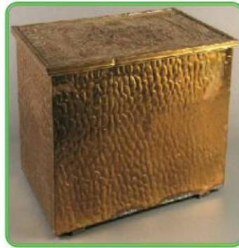
الشكل (١١٣): الطرق بالدق بالأزاميل.
