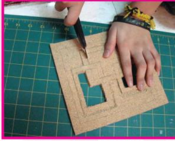
الشكل (١٣١-ج)، التفريغ على الفلين المضغوط
