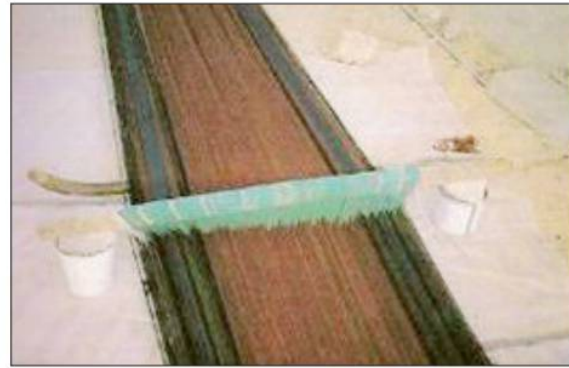
الشكل (١٧٥): نول السدو الأفقي ويلاحظ فيه تقارب خيوط السدى ببعضها.
