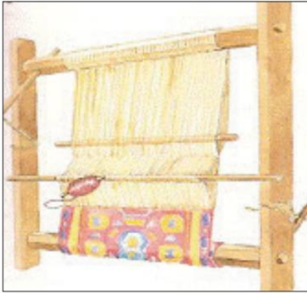
الشكل (١٧٦): نول الكليم ويلاحظ فيه تباعد خيوط السدى بما يتناسب مع التصميم المرسوم.
