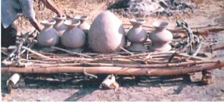
الشكل (٣٦): الطريقة التقليدية لتجفيف البطانات.
