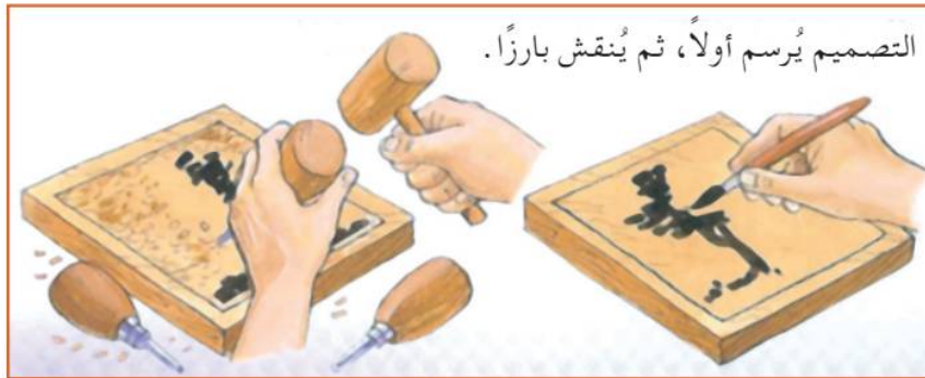
الشكل (١١٤): طريقة تنفيذ الإشارات بالحفر على الخشب.
