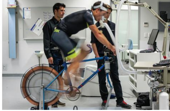
الشكل رقم (3-5) جهاز قياس الاستهلاك الأقصى للأوكسجين (Vo2max).
