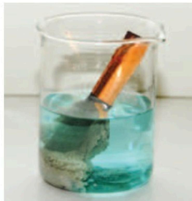
٨. توضح الصورة أعلاه عملية تفاعل النحاس Cu مع نترات الفضة  $\text{AgNO}_3$  لتكوين نترات النحاس  $\text{Cu}(\text{NO}_3)_2$  والفضة Ag حسب المعادلة التالية:
