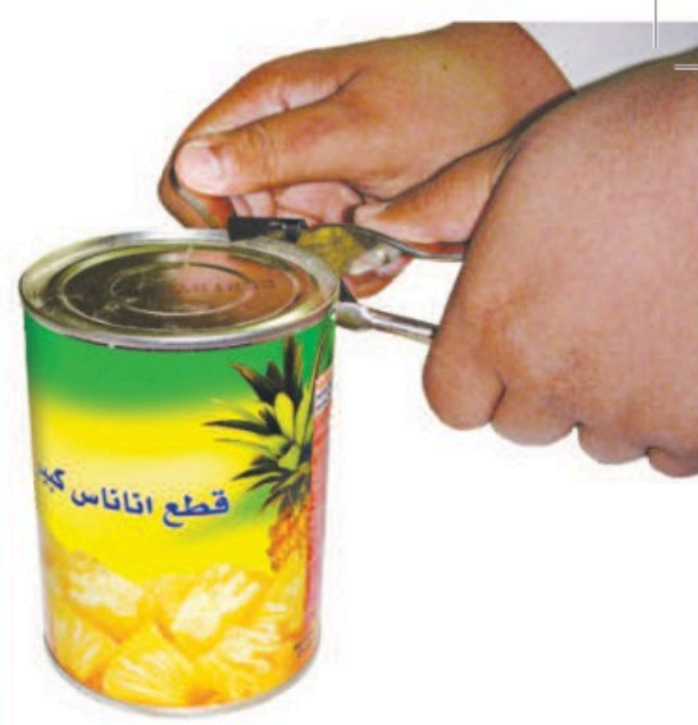
الشكل ١٩ مفتاح العلب يحول القوة الصغيرة من يدك إلى قوة كبيرة على النصل الذي يقطع غطاء العلبة.
