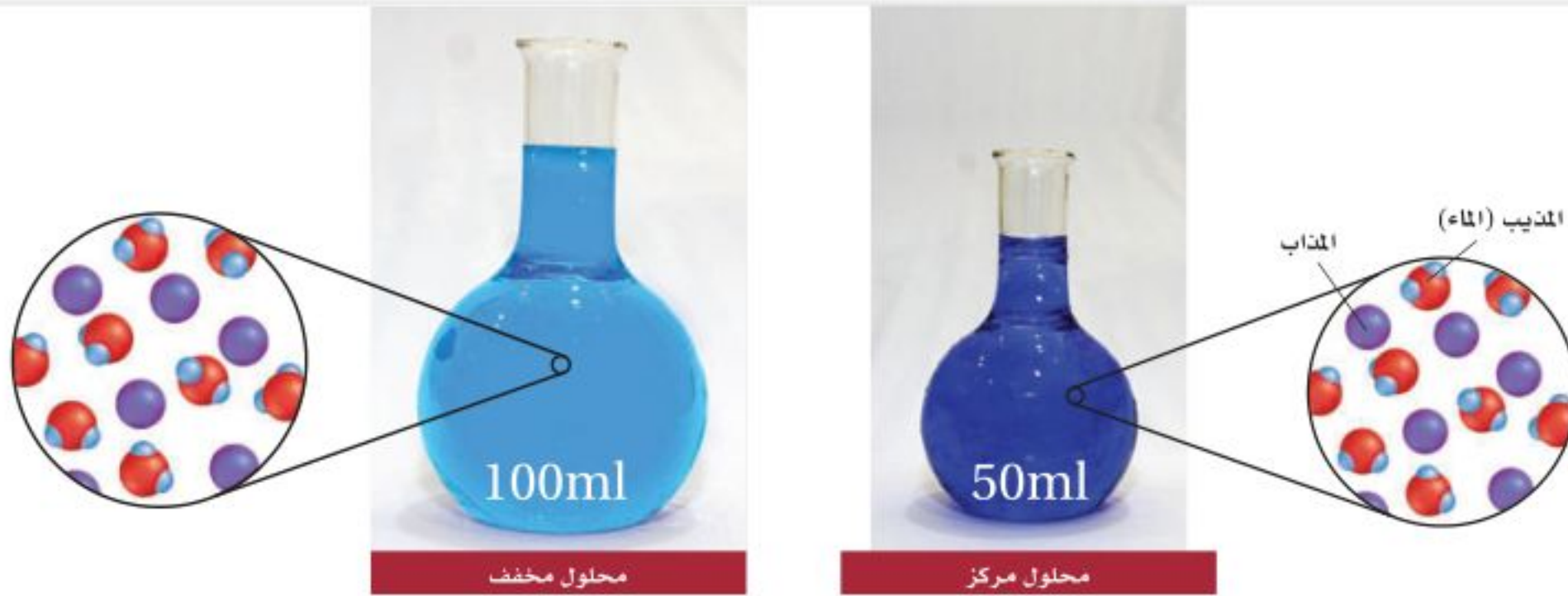
الشكل 1-6 يمكن تخفيف المحلول المركز بإضافة كمية من المذيب. لاحظ أن عدد مولات المذاب لا يتغير عند تخفيف المحلول المركز.
