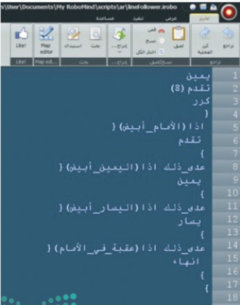
شكل (٢-٥-١١): برمجة الروبوت للسير على الخط الأبيض
