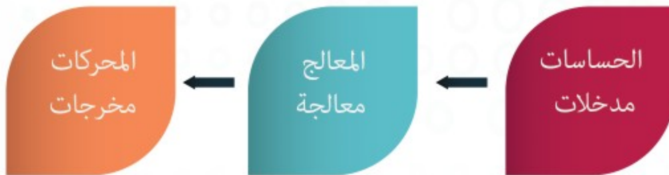
شكل (٦-٢): العلاقة بين مكونات الروبوت
