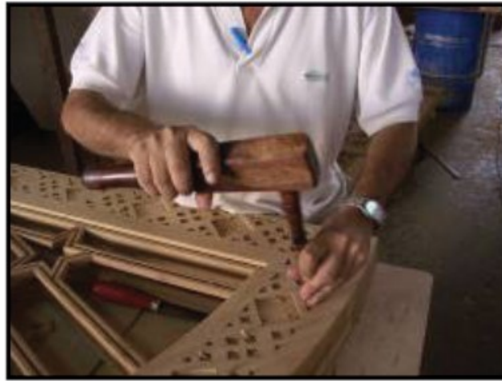
( ١ ) : استخدام المدق الخشبي ، وهي الأداة الصحيحة .
