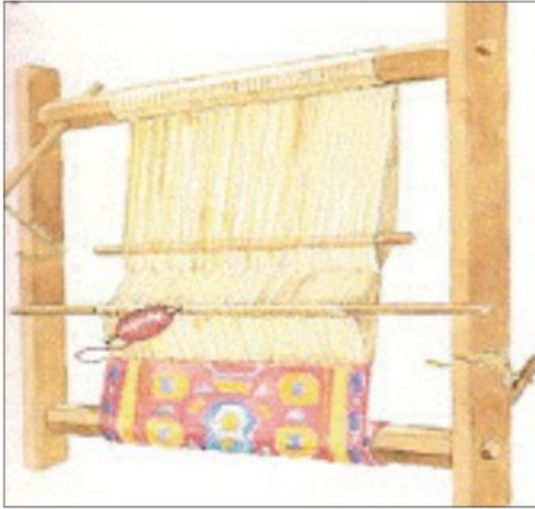
الشكل ( ٧٩ ) : نول الكليم ويلاحظ فيه تباعد خيوط السدى بما يتناسب مع التصميم المرسم .
