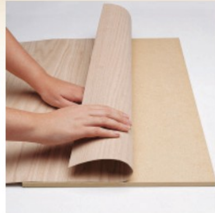
الشكل ( ٦٢ ) : تستخدم القشرة لتغطية الأسطح الخشبية على مساحات كبيرة .
