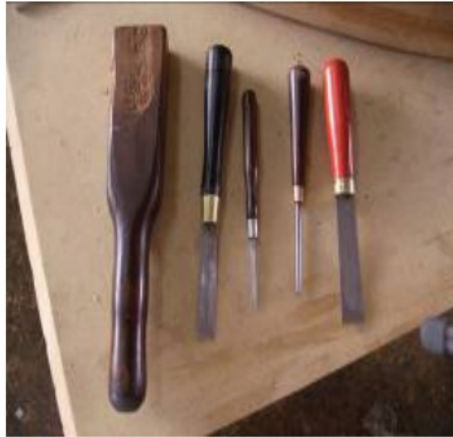
الشكل (٥٨): الأدوات التي يستخدمها الفنان في الحفر على الخشب، مجموعة أزاميل، ومدق خشبي.
