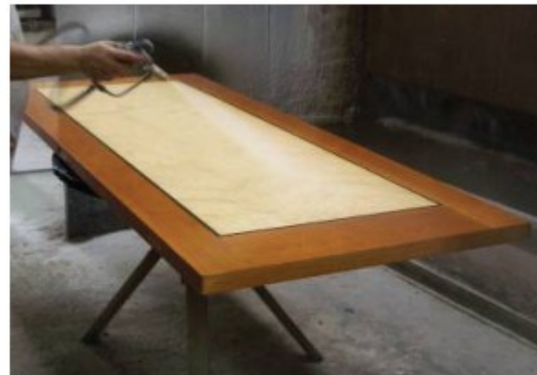
الشكل ( ٦٤ ) : باب خشبي مغطى بثلاثة أنواع من قشرة الخشب . ويلاحظ أن الحرفي يقوم بتغطيته بطبقة من الورنيش لحمايته .
