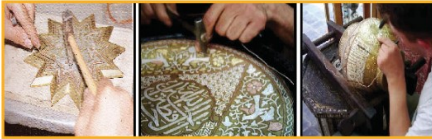
الشكل (٣٥): طريقة التكفيت
