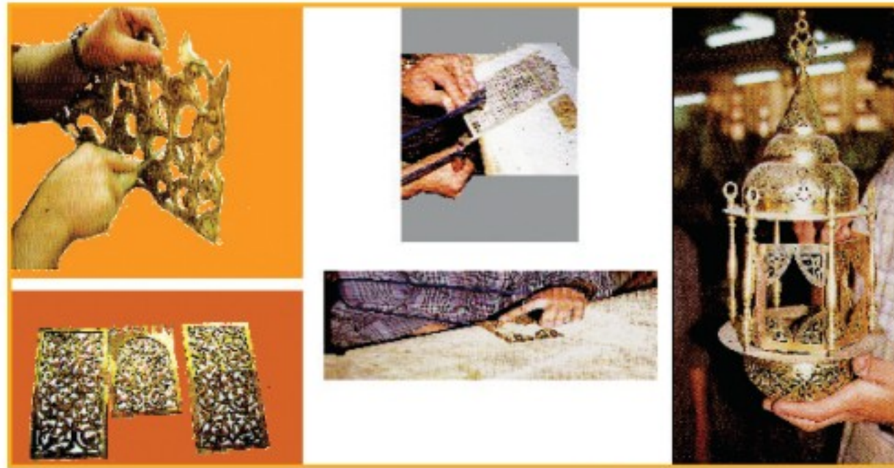
الشكل (٨)، طرق استخدام أزاميل ومنشار المعادن
