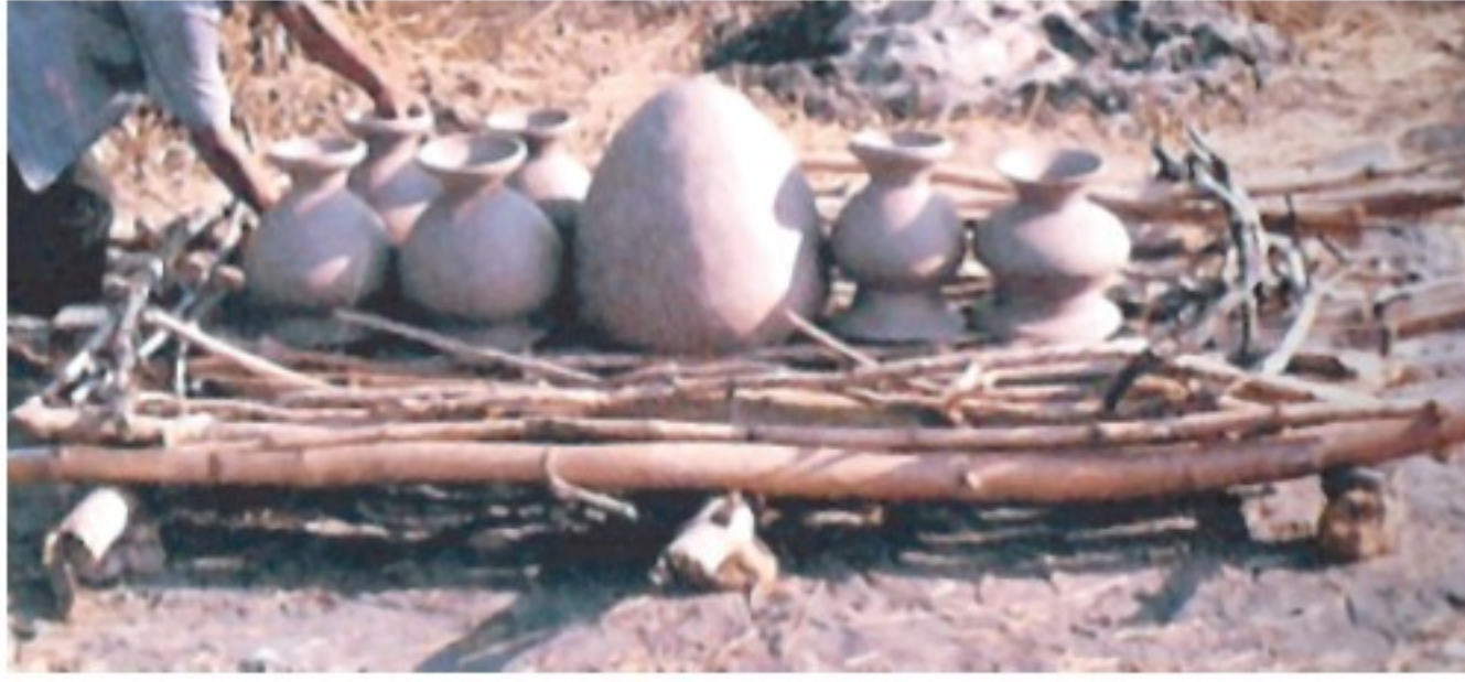
الشكل ( ١٥ ) : الطريقة التقليدية لتجفيف البطانات .
