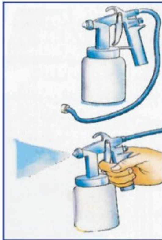
الشكل (١١) : بخاخة موصلة بمضخة .
