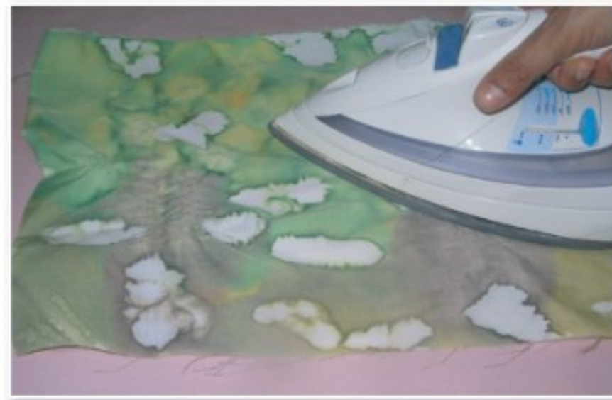
الخطوة (٦) : كي القماش بعد الطباعة . الشكل (١٣٦)
