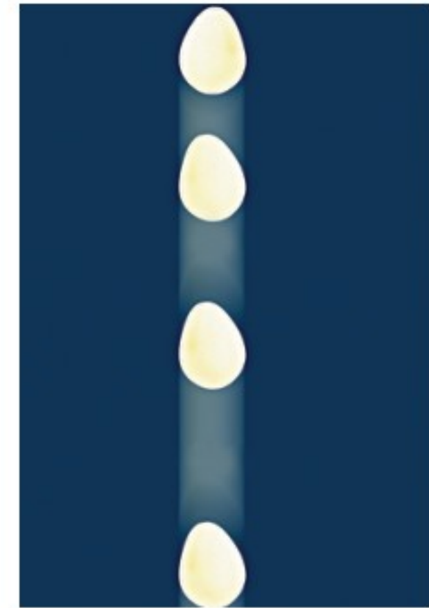
الشكل 14-3 صورة ستروبية (تصوير زمني سريع متتابع) لبيضة تتسارع بمقدار 9.80 \text{ m/s}^2 في أثناء السقوط الحر. فإذا تم اختيار الاتجاه الموجب إلى أسفل فإن كلاً من السرعة المتجهة والتسارع لهذه البيضة التي تسقط سقوطاً حراً يكون موجباً.
